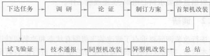
图 1.1 机载设备改装的一般程序
