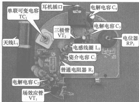
图 1-6 超小型收音机的内部结构
