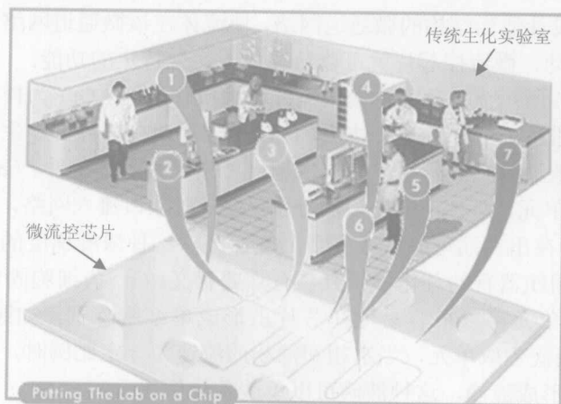
图 1-3 “微流控芯片实验室”概念展示，数字代表不同的操作单元
