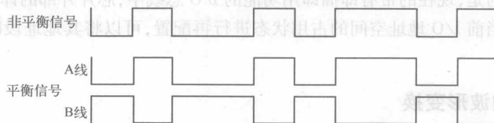
图 1.5 非平衡和平衡信号波形
