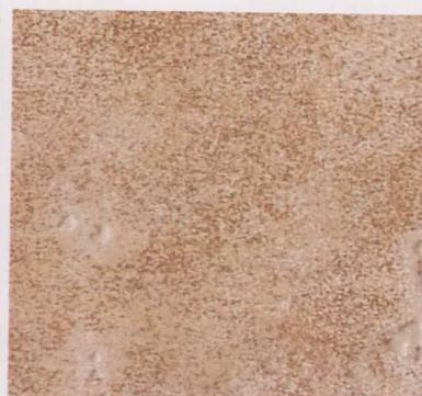
在建筑工程中，陶瓷是最古老的装饰材料之一。陶瓷强度高、耐火、耐久、耐酸碱腐蚀、耐水、耐磨、易于清洗，加之生产简单，故而用途极为广泛。常用的瓷砖有釉面砖、抛光砖、玻化砖和马赛克。
