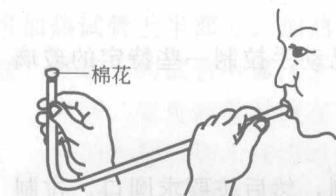
图3.9 吹气法弯曲玻璃管
