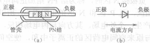
图 1.4 二极管结构与符号
