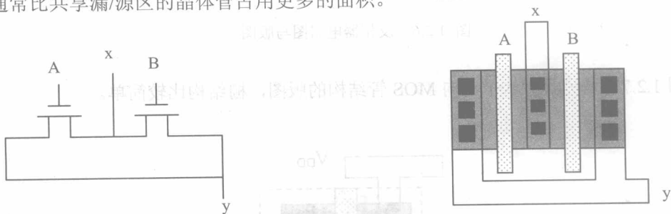
图 1.2.4 并联晶体管电路图与版图
