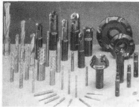
(a) 硬质合金涂层立铣刀和可转位球刀、面铣刀等
