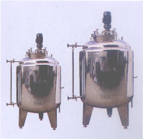
图版3-3 配液缸（带自动搅拌器）
