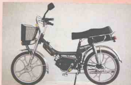
浙江绍兴天力实业公司生产的那派牌TL500链传动助力自行车,以汽油发动机作动力,同时又保留人力骑行装置,具有设计科学、驾驶灵活、维修简便、骑行安全舒适等特点。该车所用IE35F2B汽油发动机,曾获省、市科技进步奖,被评为国家级新产品。
