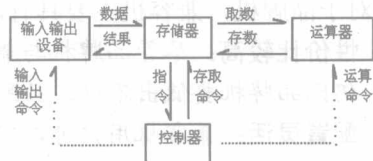
图 1-2 硬件系统的基本工作过程
