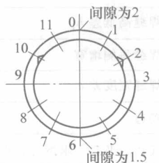
图 1-19 装配间隙与定位焊示意图
