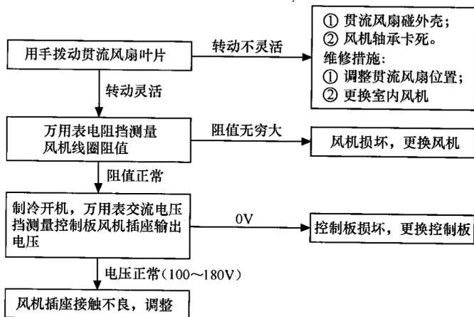
注:室内风机不运行故障,实际检修中,风机轴承损坏所占比例较小。
