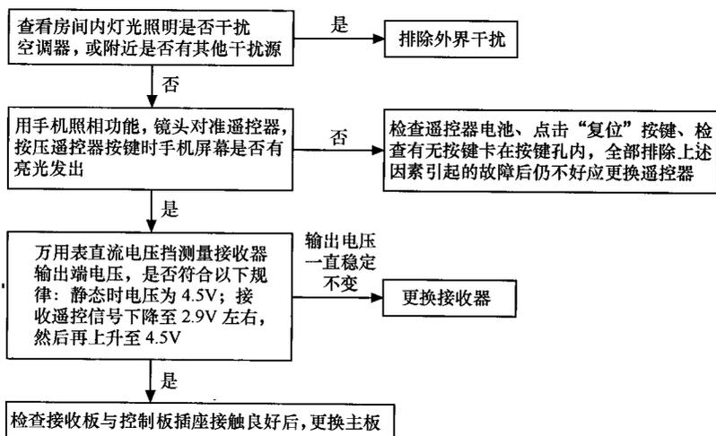
注:实例检修中,遥控不能开机故障 80%由遥控器和接收器故障引起,外界干扰和主板损坏只占很小的比例。
