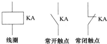
图 1-5 电磁式继电器 图形、文字符号
