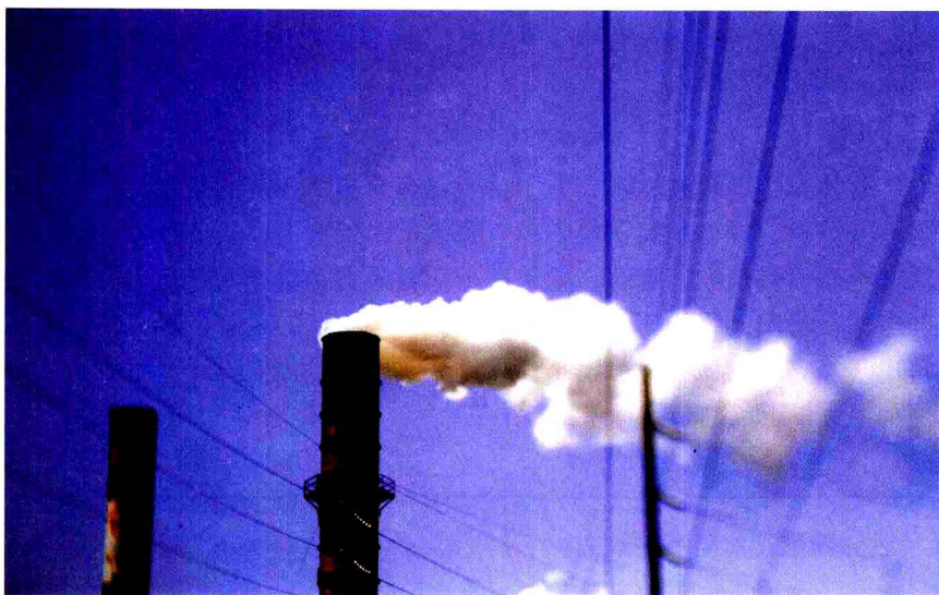
■ 图20-12 从高大的烟囱中排出的煤灰是煤燃烧的产物。静电除尘器可用来减少煤灰的排放量。
