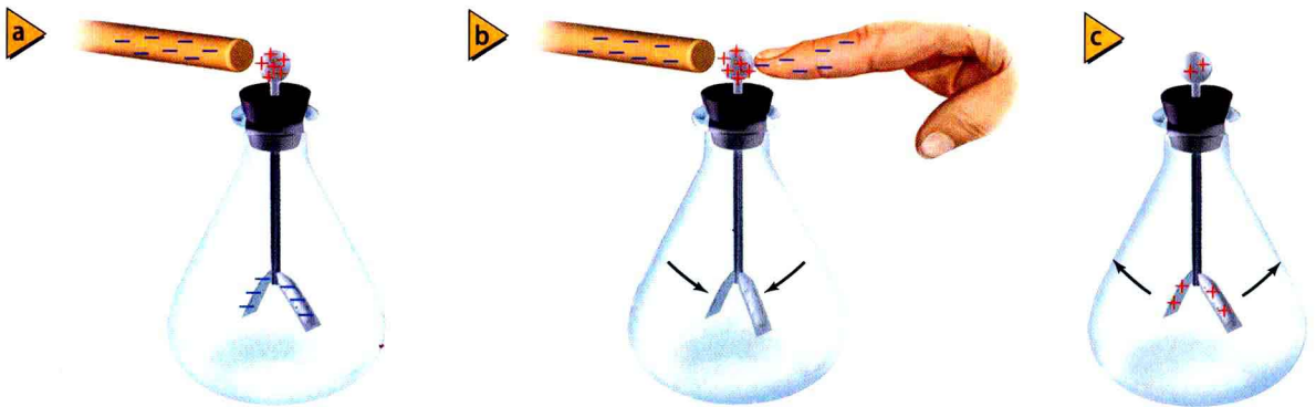
■ 图20-9 带负电的棒引起验电器中的电荷分离(a)。如果验电器接地，负电荷就会从验电器转移到大地中(b)。撤除接地，再移走带电棒，验电器上便只留下了正电荷(c)。
