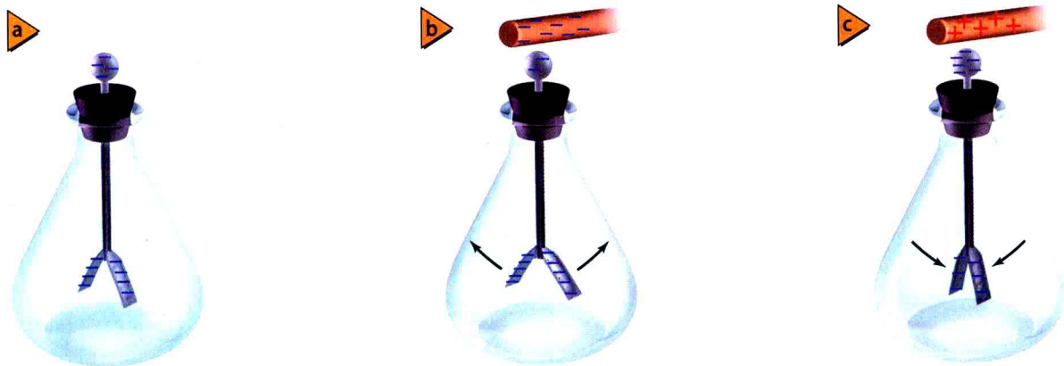
■ 图20-7 验电器带负电后，它的两片金属箔片将分开(a)。带负电的棒将电子推向箔片，使金属箔片分得更开(b)；而带正电荷的棒吸引了一些电子，从而使两片金属箔片并拢些(c)。
