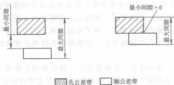
图 2-5 间隙配合公差带图
