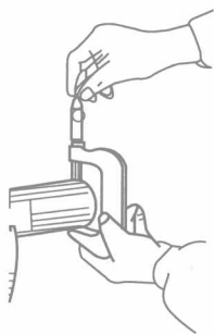
图 1-11 用外径千分尺测量外径尺寸
