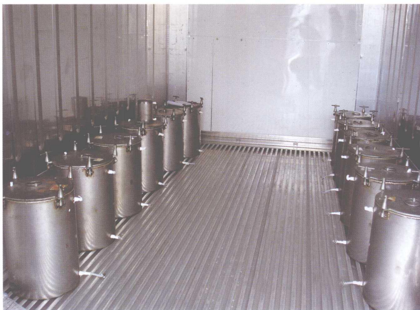
图2 天津检验检疫局研制的熏蒸桶
