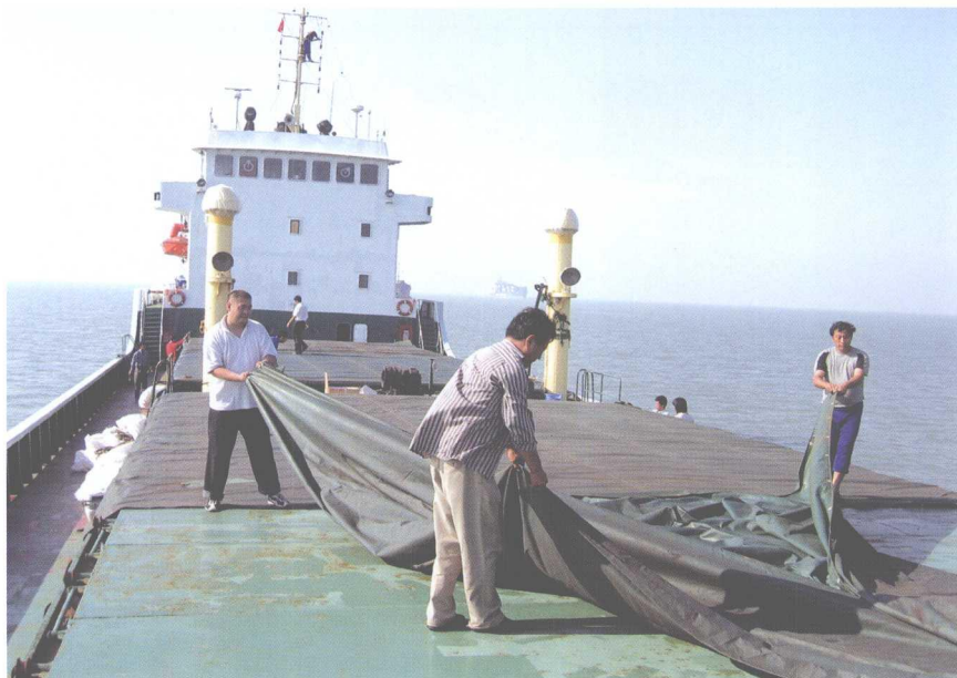
图3 船舶熏蒸通风孔和舱盖的密封
