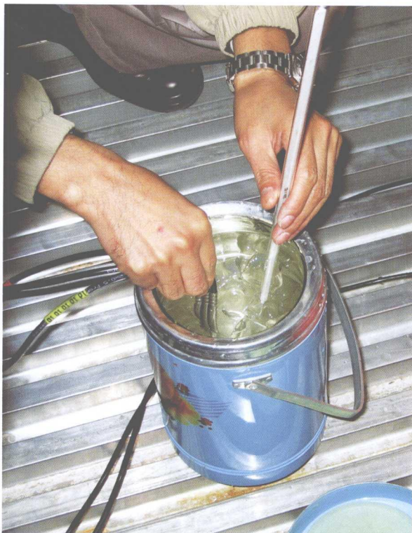
图9 冷处理温度探头的校准
