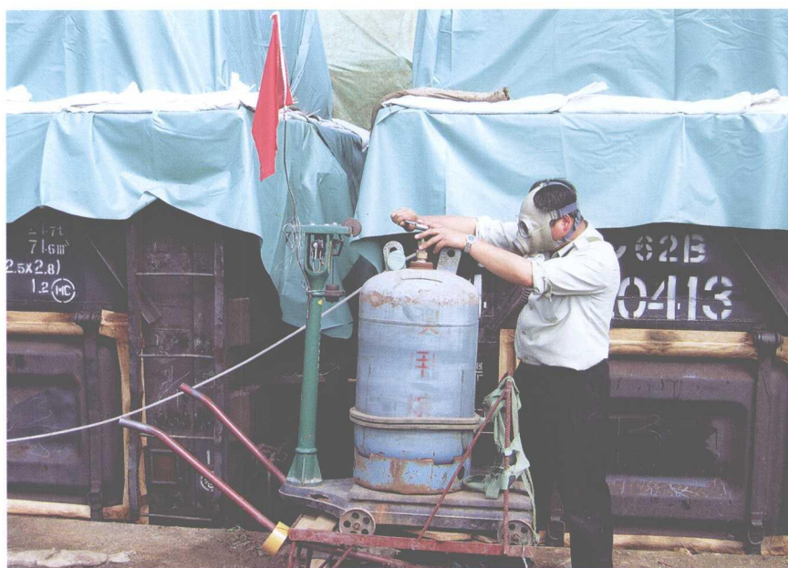
图4 火车原木熏蒸的投药
