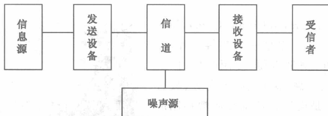
图 1-2 通信系统模型
