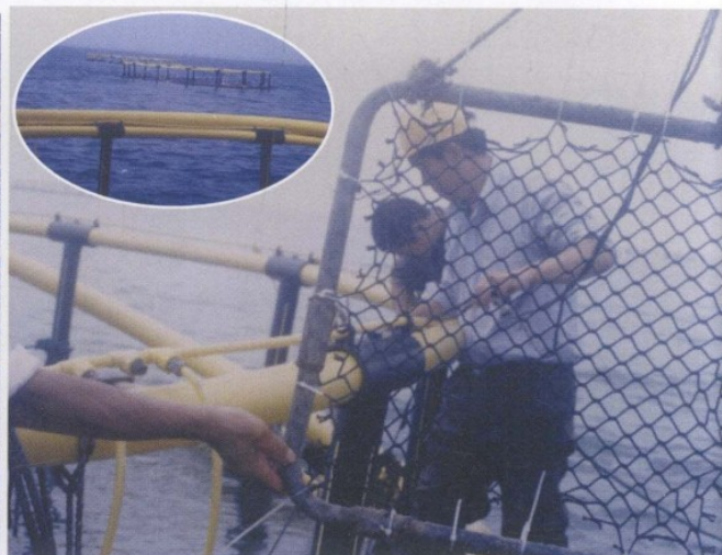
2004-2005年，在福建围头湾远岸深水抗风浪网箱挂放网片进行污损生物试验。记录了污损生物154种及逐月、逐季网片生物的数量和附着季节，为深水网箱防污提供理论依据。
