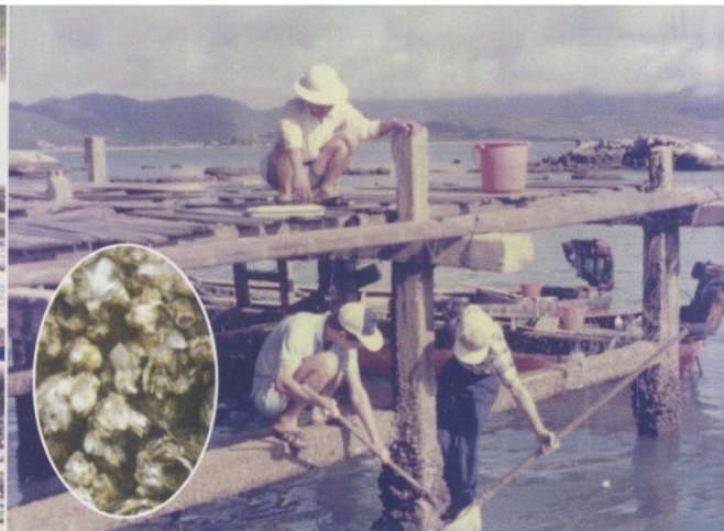
在码头桩柱进行污损生物取样，这项研究已在全国沿海，自渤海湾四号石油平台、吕四洋水文平台、厦门、北部湾、香港和西沙系统进行，方法已编入海洋调查规范国家标准GB/2763。
