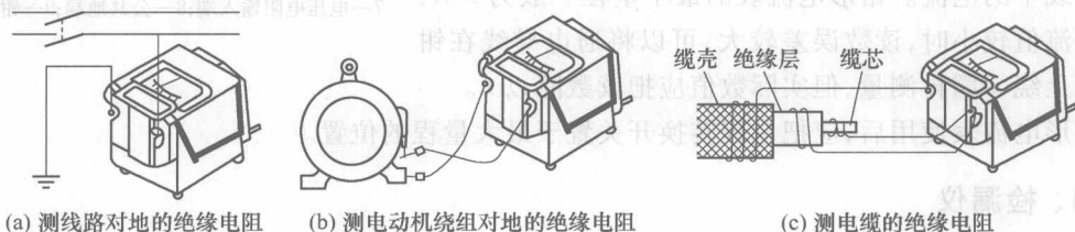
图 1-4 绝缘电阻表的接线
