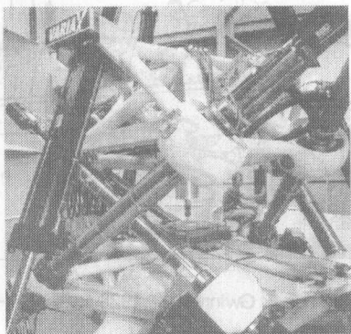
图 1-3 Giddings &amp; Lewis 公司在 1994 年推出的并联机床“VARIAX”
