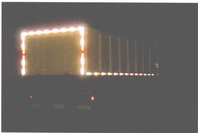
图1-3 反光材料勾勒车辆车身轮廓
