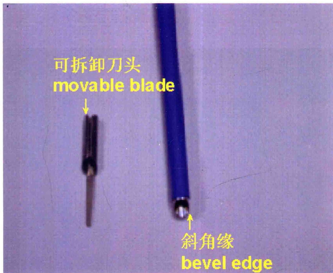
图 1-3 金属功能管与可拆卸的电刀片
