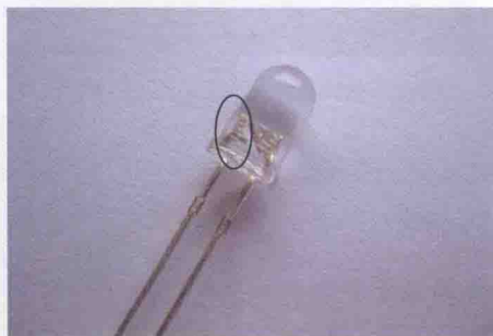
图 1-1-15 透明壳内小金属片连接的是 LED 的正极
