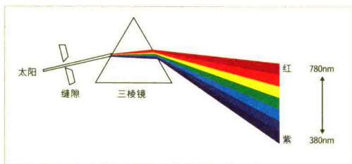
图2 即使是可见光，也看得到波长不同的色彩。通过三棱镜的光因玻璃而产生折射，波长相异的电磁波被分离，出现了光谱色，看起来与彩虹的颜色很相似。
