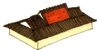
中邸住宅 (京成、17世紀後) 高切造：妻側屋根と風置屋根との組み合わせ
