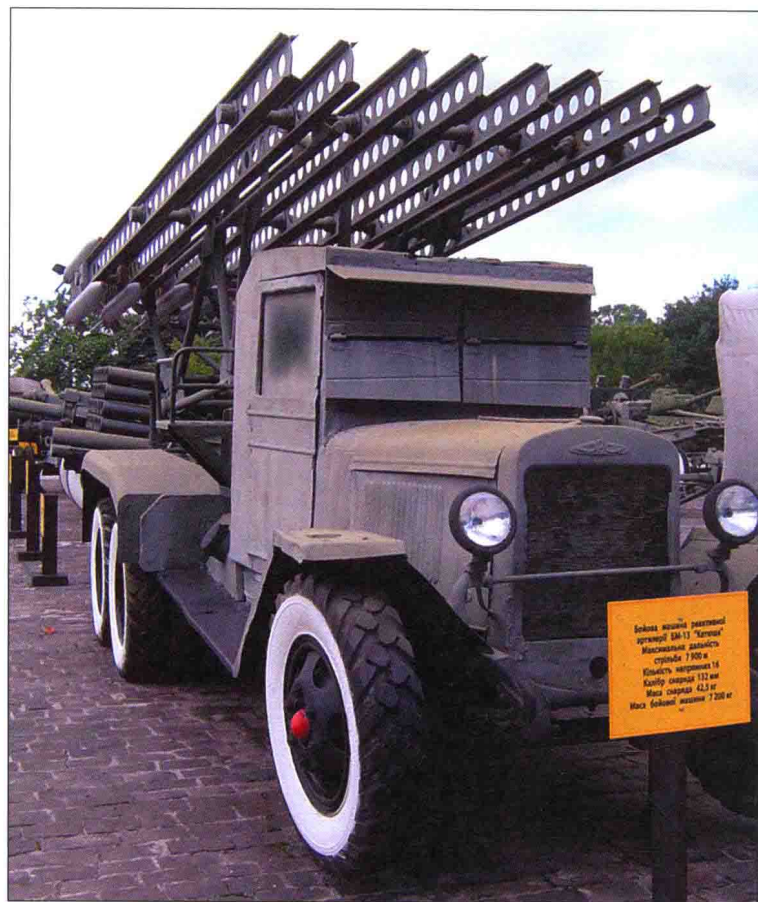
▲ 苏联的 BM-13“喀秋莎”有一排导轨，它们被固定在 ZIS-6 卡车上。发射时，16 发 M-13 火箭弹沿着这些导轨滑动冲出。
