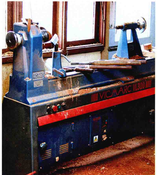
如果你需要加工较重的长轴物件，就需要购买一台类似于维克马克长身车床的车床
