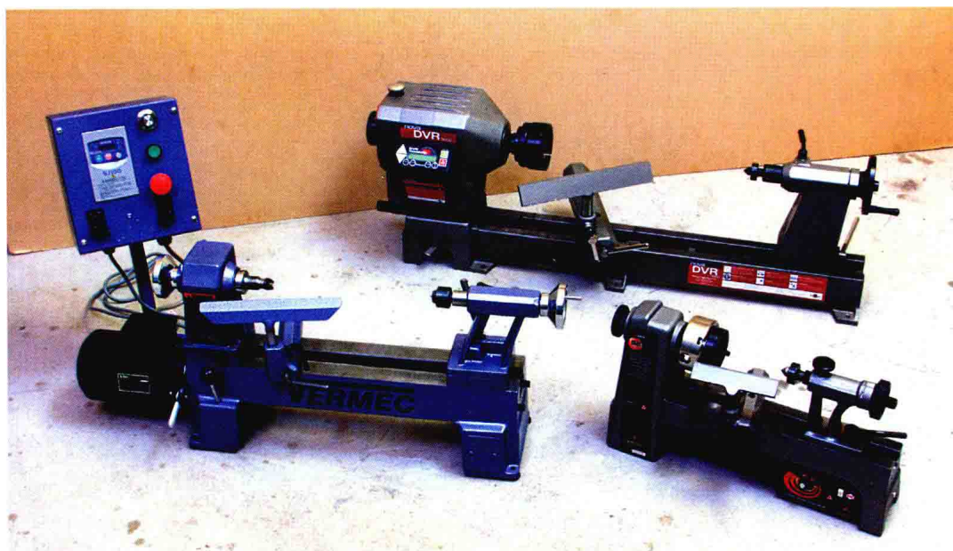
图中左边和后边的车床的最大加工直径为 305 毫米，它们适合绝大多数木旋爱好者使用。如果你要做小物件，右边这台迷你车床就足够了
