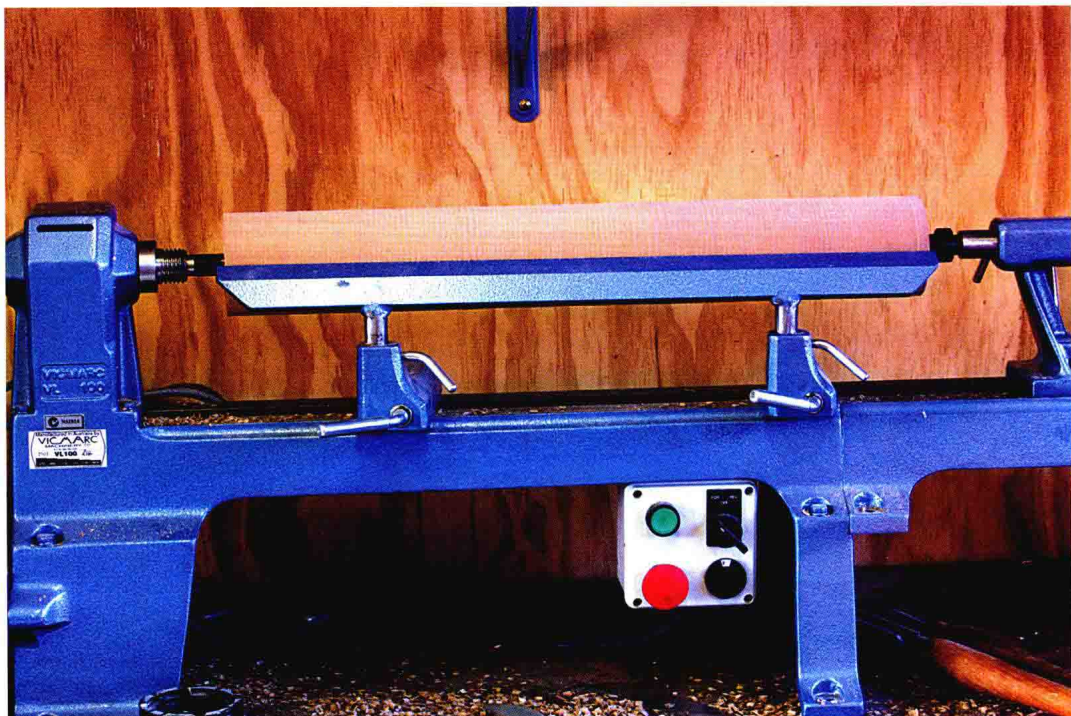
当你旋切很长的物件时，一个长车刀架能有效节省设置时间
