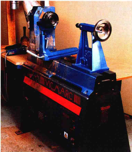
这台车床不但适合制作小物件，还能加工重达 40 千克的木料，而且配上延长床身后可制作较长的物件
