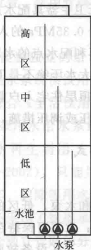
图 1-14 无水房并联给水方式
