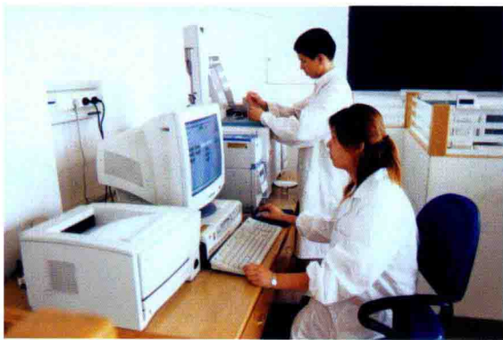
农产品监测中心的技术人员正在操作气质联用仪检测设备，对生猪尿样进行 \beta -兴奋剂检测
