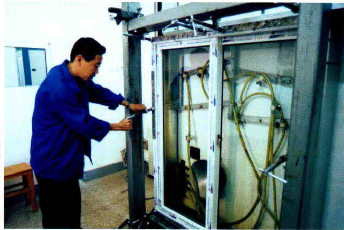
建材检验室的技术人员正在对塑钢门窗进行检测
