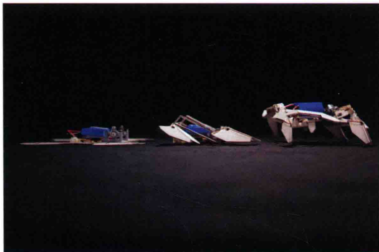
图 1-2 哈佛大学和麻省理工学院的这个机器人由纸和热敏形状记忆聚合物制成,可以自行合拢和弹开。 作者:哈佛大学 Wyss 研究所, Seth Kroll
