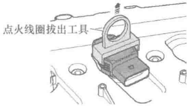
拆卸点火线圈
