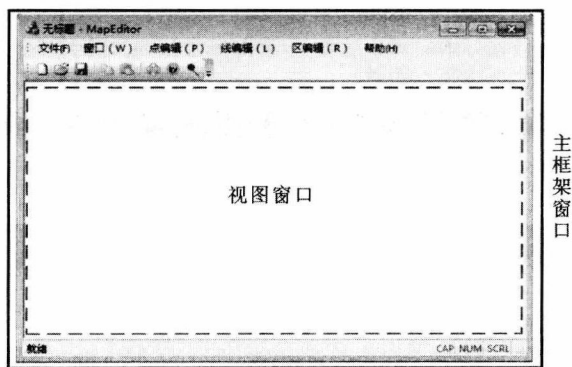
图 1.3 MFC 应用程序框架各组成部分及其关系
