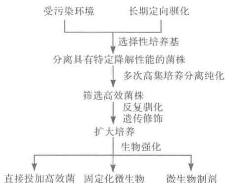
图1.2 利用常规微生物学手段筛选和生产高效菌株流程(王建芳等,2007)
