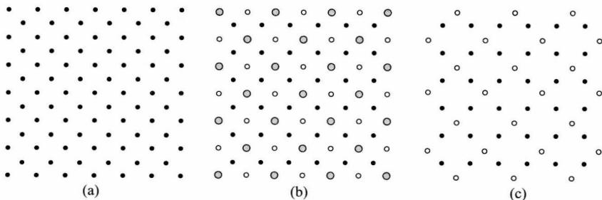
解：晶体(a)的结构基元由1个粒子构成：1个B粒子。以B粒子处的点代表结构基元，得到其点阵，如图1-16-1(a)所示。
