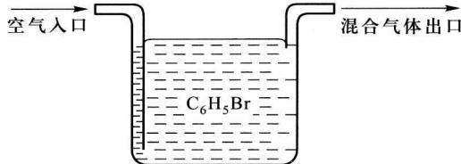
解: (1) 由题意可知, 当干燥的空气通过溴苯并被饱和后, 混合气体的总压不变, 仍为起始压强  $p_{\text{总}} = 101 \text{ kPa}$ 。由于溴苯的加入, 混合气体的体积  $V_{\text{总}}$  将增大; 混合气体总的物质的量  $n_{\text{总}}$  增大。
