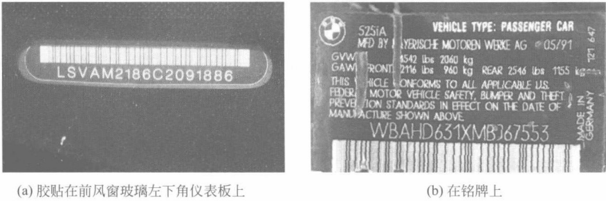
图 2-2 车辆的 VIN 码在车辆上的位置
