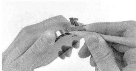
图 1-7 使用拆机撬棒拆卸外壳
