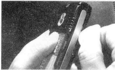
图 1-5 使用拨片拆机的方法
