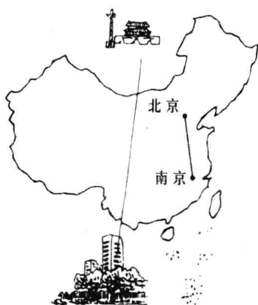
用相对误差 6 \times 10^{-9} 的精度测量北京到南京的距离，准确可达 0.5 厘米
