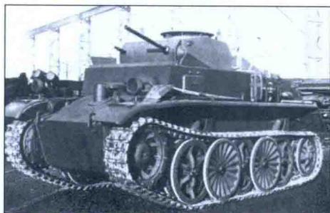
▲I号C型坦克在原基础上对负重轮、履带及引擎等部位进行了修改
