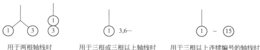
图 1-4 详图的轴线编号
