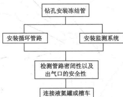
图 1-2 液氮冻结法施工一般流程
