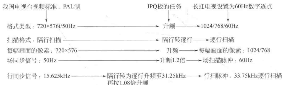
图 1-5 长虹电视机设置为 60Hz 逐点扫描接收电视节目时 IPQ 板的任务
