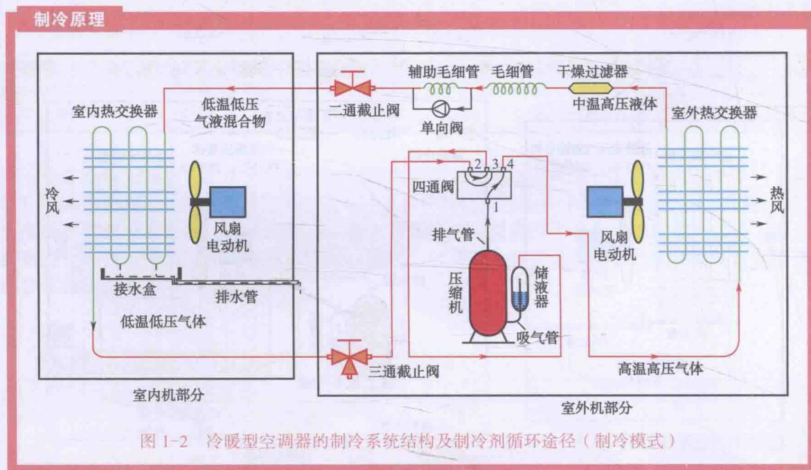
图 1-2 冷暖型空调器的制冷系统结构及制冷剂循环途径（制冷模式）
