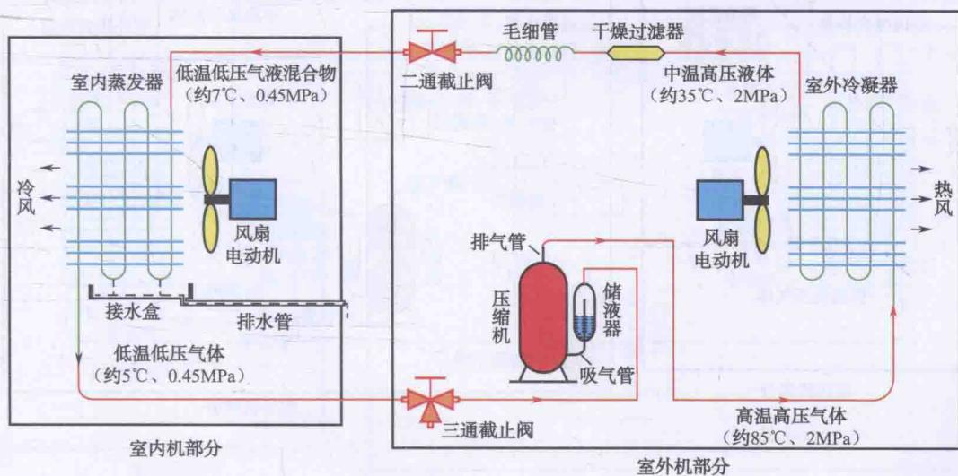
图1-1 单冷型空调器的制冷系统结构及制冷除湿原理说明图
