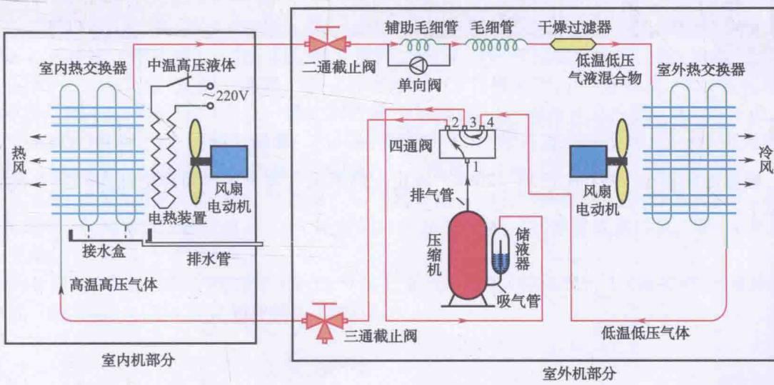
图1-3 冷暖型空调器的制热系统结构及制冷剂循环途径（制热模式）
