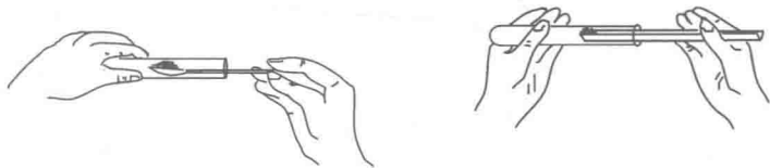
图 1-3 试管中固体试样的加入方法
