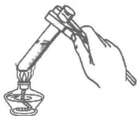
图 1-6 试管中溶液加热的错误操作
