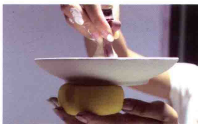
图 2-2-12 待坯体吸附一定厚度的釉后将盘子提起，用海绵擦拭底部多余的釉
