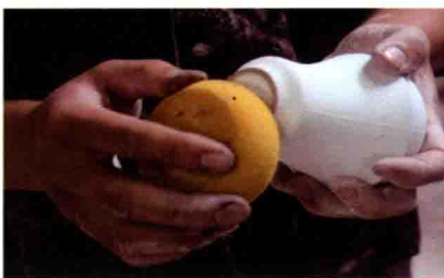
图 2-2-8 待釉干燥后，用海绵擦拭杯子的足底（也可用刀片刮去足部的釉）
