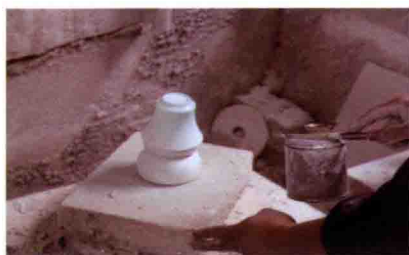
图 2-2-7 开始吹釉，转动转盘使釉均匀地覆盖坯体
