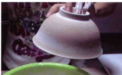
图 2-2-18 迅速将碗倒扣，将多余的釉倒回桶中
