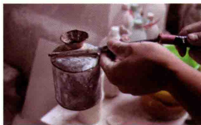
图 2-2-6 连接吹釉机皮管
