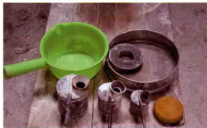
图 2-2-3 吹釉时使用的瓢、筛子、釉壶、海绵
