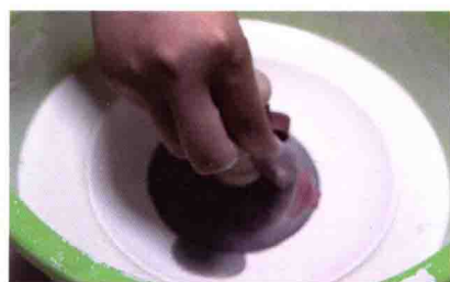
图 2-2-11 手持手柄将盘子浸入调好的釉中，注意盘子边缘要与釉面保持水平
