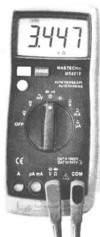
图 1-5 用万用表测量电阻的方法
