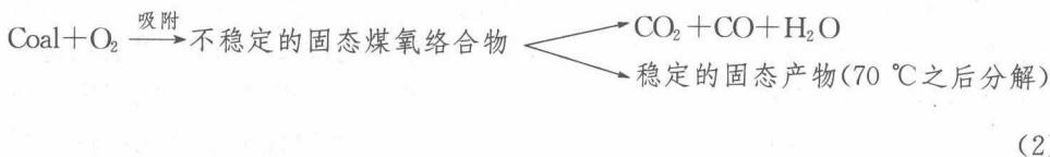
该模型认为煤自燃过程存在两个平行的反应序列，即煤氧接触的直接氧化反应(1)和吸附在煤体上的煤氧进一步氧化过程(2)。其中，煤对氧的化学吸附
