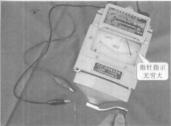
2-4 实际测量前，红黑测试夹分开（开路），需对兆欧表进行开路测试，顺时针摇动摇杆，指针应指示无穷大
