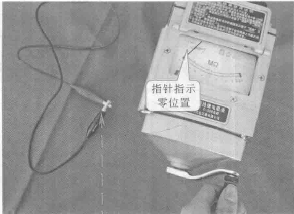
2-5 实际测量前，还需要将红黑测试夹连接在一起（短路），对兆欧表进行短路测试，顺时针摇动摇杆，指针应指在0位置上
